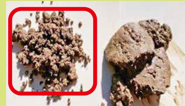
土壌が団粒化された様子 左側がドクターペーパー CaP円筒の土壌
