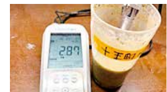
酸性硫酸塩土壌のpH値をH 2 O 2 で測定すると、3.5以下の強酸性が確認される。
